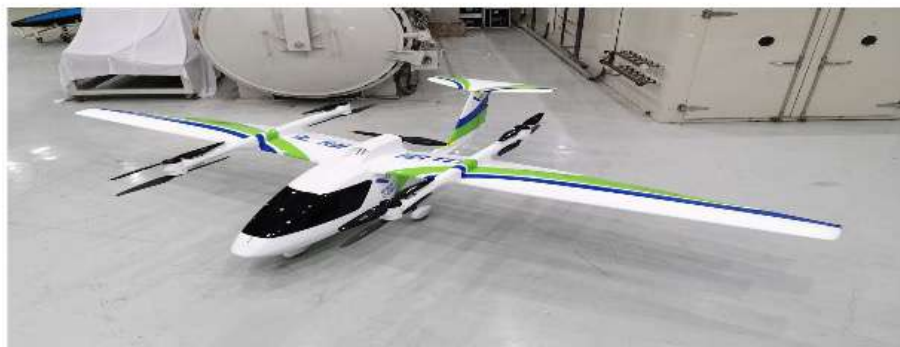
复合翼垂直起降无人机 (中国商飞), 最大功率150kW
