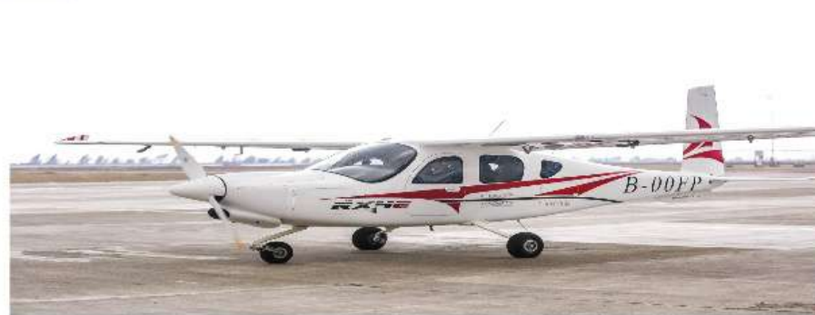
锐翔RX4E电动飞机 (辽宁锐翔), 最大功率140kW
